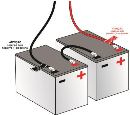
**ATENÇÃO: OS CABOS DAS BATERIAS DEVEM SER DE NO MÍNIMO 2,5mm<sup>2</sup> COM NO MÁXIMO 50cm DE COMPRIMENTO.**
