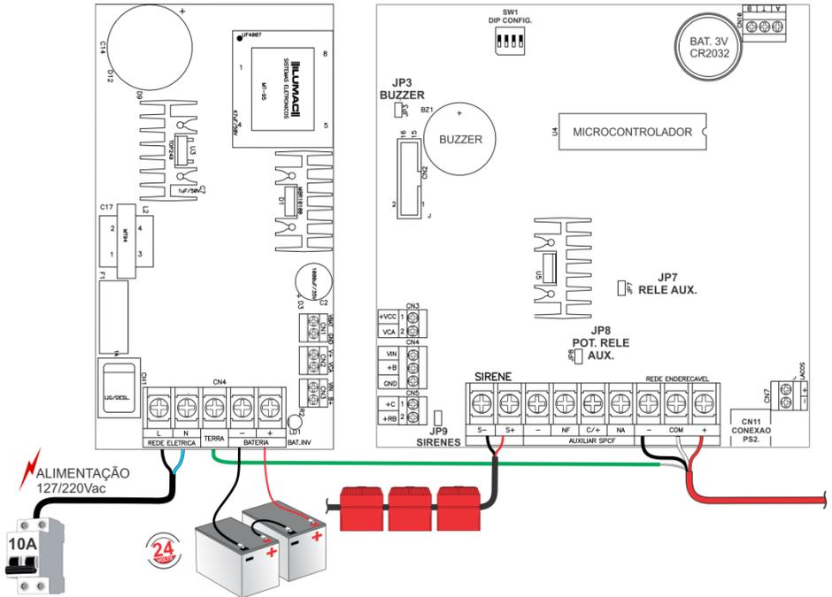
O cabo é conectado à central e aos dispositivos seguindo o padrão de cores:
