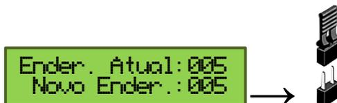
(5) Quando o endereço mostrado na primeira linha for o desejado, o endereço foi gravado com sucesso no dispositivo. Remova o jumper de programação, anote o endereço dado ao dispositivo e repita os procedimentos para o próximo dispositivo a ser endereçado.
