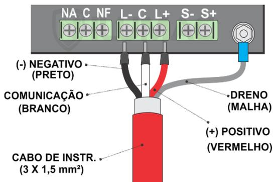
**Todo cabo de comunicação possui alta resistência elétrica natural dos fios de cobre e alta capacitância devido à arquitetura de montagem. Por isso tais fatores como a RESISTÊNCIA e CAPACITÂNCIA podem influenciar no sistema e prejudicar na comunicação entre a central e os dispositivos de campo.**
