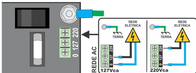
A central aceita alimentação de rede elétrica 127 ou 220 VCA em 60 Hz com seleção através da conexão nos bornes como mostra a imagem ao lado.
