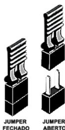
No interior da central podem ser identificados os jumpers de configuração que auxiliam durante a instalação para inibições de algumas funções. **Jumper fechado habilita a função.** É necessário inicializar a central após alterações.
