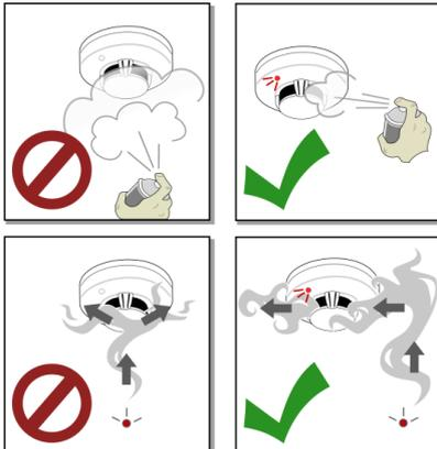
**ATENÇÃO:** Após testes realizados, certifique-se de que não há resíduos de spray de teste ou fumaça na câmara do detector antes de reinicializar a central.
