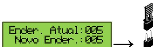
(5) Quando o endereço mostrado na primeira linha for o desejado, o endereço foi gravado com sucesso no dispositivo. Remova o jumper de programação, anote o endereço dado ao dispositivo e repita os procedimentos para próximo dispositivo a ser endereçado.
