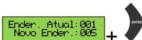
(4) Neste momento a central muda o endereço do dispositivo, deixando gravado o endereço selecionado na segunda linha dentro da memória do próprio dispositivo. Quando este processo ocorre com sucesso o dispositivo passa a informar seu endereço novo, aparecendo na primeira linha.
