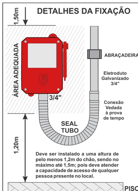
O acionador AMPW-E suporta ambientes externos de nível IP66, entretanto a instalação deve ser executada por profissionais capacitados, sendo feito o posicionamento adequado e a vedação de emendas e tubulações.
