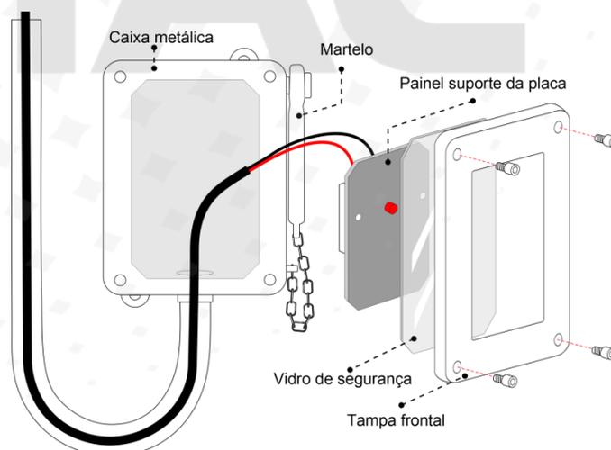
O acionador AMPT-C suporta ambientes externos de nível IP65, entretanto a instalação deve ser executada por profissionais capacitados, sendo feito o posicionamento adequado e a vedação de emendas e tubulações.
