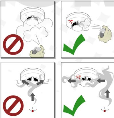
Para o teste com fumaça real, utilize uma fonte de fumaça densa sem fogo. Posicione a fonte de forma que a fumaça alcance o detector lateralmente por acúmulo na superfície onde está instalado.
