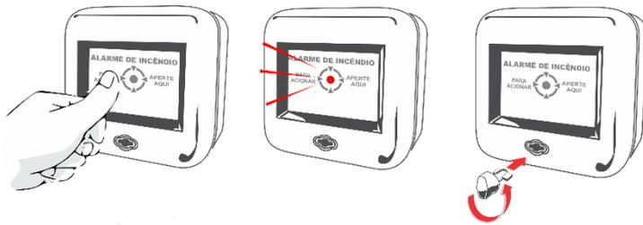
Para retornar à supervisão basta inserir a chave de rearme no encaixe disponível na face frontal e girá-la no sentido horário até que a placa destrave, voltando à posição inicial, e o LED deixe de ficar aceso em VERMELHO.
