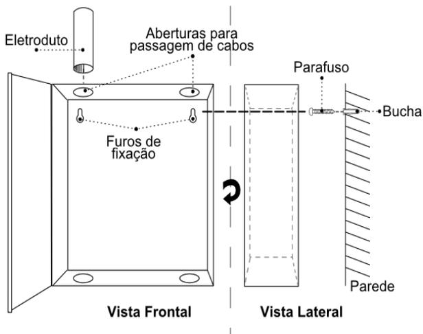
O painel repetidor possui dois furos de fixação por sobrepor que permitem que fique firmemente preso à parede e possa ser removido facilmente em caso de manutenção.
