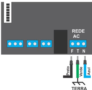
O painel possui uma **fonte** chaveada full-range que deve ser alimentada exclusivamente pela **rede elétrica** local, aceitando tensão de **100 a 240Vac**. Possui circuito de filtro e proteção contra transientes, com fusível de vidro de **2A**.
