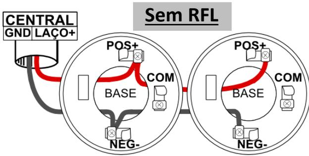
Centrais convencionais com supervisão utiliza **resistor de final de linha (RFL)** para identificar a abertura do circuito do laço. Utilize a montagem abaixo para que o circuito acuse avaria na central caso o detector seja removido da base.
