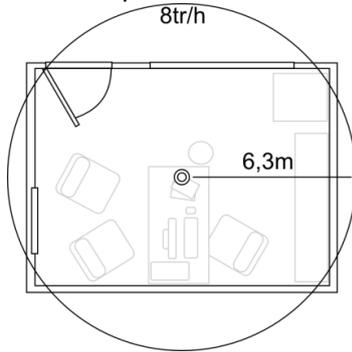
O detector deve ser instalado em superfície **plana** ou com vigas de até 20cm, com **altura de até 8m**, em ambiente livre e desobstruído.
