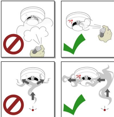
Para o teste com fumaça real, utilize uma fonte de fumaça densa sem fogo. Posicione a fonte de forma que a fumaça alcance o detector lateralmente por acúmulo na superfície onde está instalado.
