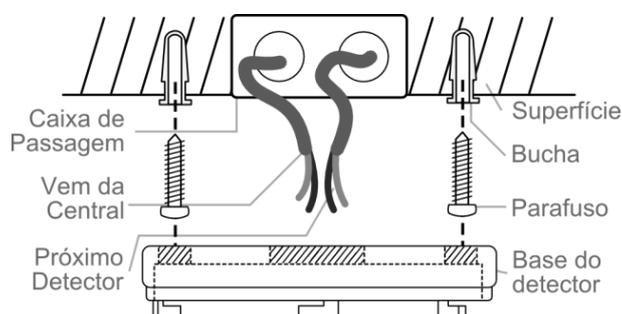
O sistema convencional de dois fios utiliza as mesmas vias de alimentação para sinalização de alarme entre detector e a central. Verifique o manual da central para maiores detalhes.
