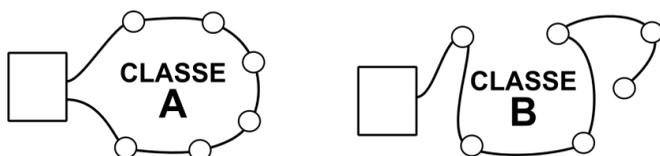
Para perfeito funcionamento do sistema deve-se adotar a topologia linear para encaminhamento do cabo. Outros tipos de topologia, tais como, árvore, ramificadas e/ou com derivações podem provocar falhas no sistema.
