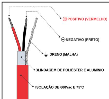
Todo cabo de comunicação possui alta resistência elétrica natural dos fios de cobre e alta capacitância devido à arquitetura de montagem. Por isso tais fatores como a resistência e capacitância podem influenciar no sistema e prejudicar na comunicação entre a central e os dispositivos de campo.
