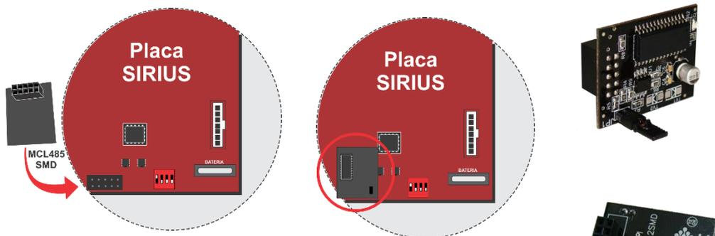
Após conexão da placa MCL485 ajuste os Dips de configuração conforme imagem abaixo:
