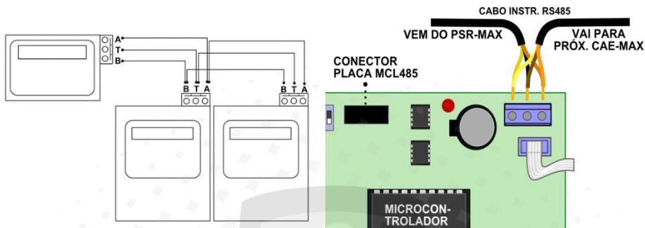
Recomendamos que o sistema seja testado por partes, ligando apenas uma central com o painel supervisor, e em seguida adicionando as demais e religando o sistema para verificar a comunicação. Dessa forma se houver algum problema de comunicação será possível identificar a causa facilmente.
