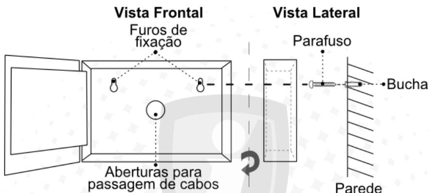
O painel supervisor possui dois furos de fixação por sobrepor que permitem que fique firmemente preso à parede e possa ser removido facilmente em caso de manutenção. Possui uma abertura traseira para a passagem dos cabos.
