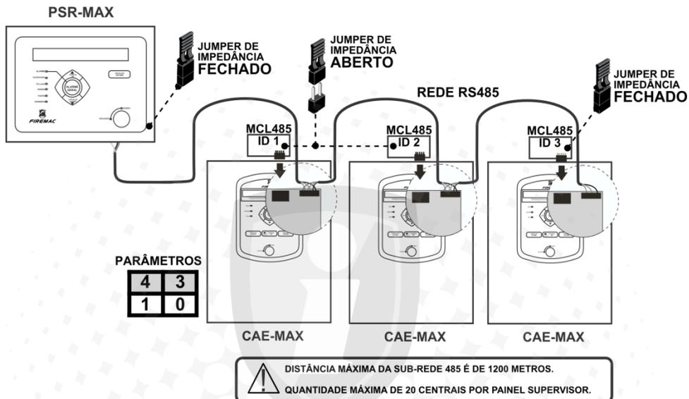
A montagem da rede deve ser feita de forma **linear**, sem qualquer derivação, formando uma linha **única** do painel supervisor até a última central da rede. Nas centrais conecta-se o cabo da rede nos bornes disponíveis na placa localizada no topo da central. O cabeamento deve chegar ao borne e dele sair para dar a continuidade da rede.
