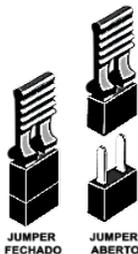
**ABERTO:** A saída é acionada em caso de alarme e é desligada quando o alarme é cancelado (dispositivo rearmado) ou ao se desligar as sirenes através da tecla “Desliga sirene”.
