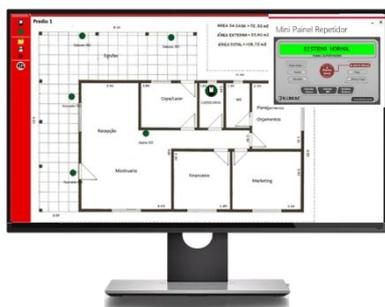
O software programador de centrais é uma ferramenta criada para o auxílio a todos instaladores e técnicos, facilitando assim todas as configurações na central. A configuração pode ser feita em modo online e offline. Compatível com as centrais da linha Sirius.
