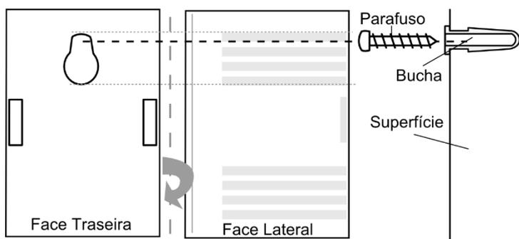
O detector deve ser instalado a uma altura de 20 a 40cm do piso, próximo ao ponto de possível vazamento de gás.
