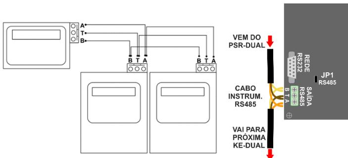
Recomendamos que o sistema seja testado por partes, ligando apenas uma central com o painel supervisor, e em seguida adicionando as demais e religando o sistema para verificar a comunicação. Dessa forma se houver algum problema de comunicação será possível identificar a causa facilmente.
