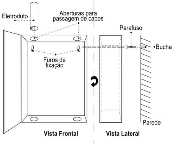
O painel supervisor possui dois furos de fixação por sobrepor que permitem que fique firmemente preso à parede e possa ser removido facilmente em caso de manutenção. Possui uma abertura traseira para a passagem dos cabos.
