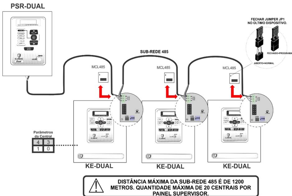
A montagem da rede deve ser feita de forma **linear**, sem qualquer derivação, formando uma linha **única** do painel supervisor até a última central da rede. Nas centrais conecta-se o cabo da rede nos bornes disponíveis na placa localizada no canto inferior esquerdo. O cabeamento deve chegar ao borne e dele sair para dar a continuidade da rede.
