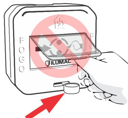
Para retornar à supervisão basta inserir a chave de rearne no encaixe disponível na face frontal e girá-la no sentido horário até que a placa destrave, voltando à posição inicial, e o LED deixe ficar aceso em VERMELHO.
