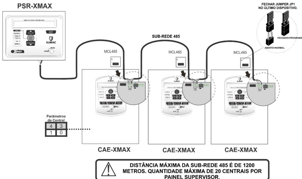
A montagem da rede deve ser feita de forma **linear**, sem qualquer derivação, formando uma linha **única** do painel supervisor até a última central da rede. Nas centrais, conecta-se o cabo da rede nos bornes disponíveis na placa, localizados no topo da central. O cabeamento deve chegar ao borne e dele sair para dar a continuidade a rede.
