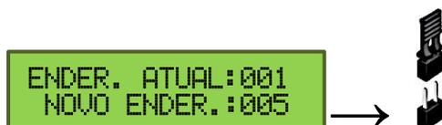
(5) Quando o endereço mostrado na primeira linha for o desejado, o endereço foi gravado com sucesso no dispositivo. Remova o jumper de programação, anote o endereço dado ao dispositivo e repita os procedimentos para próximo dispositivo a ser endereçado.
