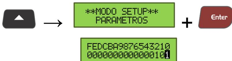
Na linha superior do display a central mostra a identificação do parâmetro que vai do numero 0 até a letra F, totalizando 16 tipos de parâmetros diferentes. Na linha inferior do display mostra os números 0 ou 1, que significa 0 = desativado e 1 = ativado.
